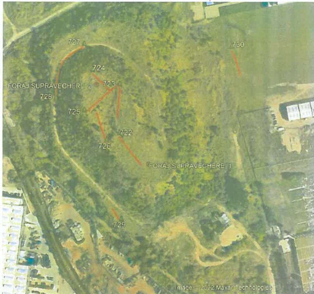
Figura 11. Poziționarea forajelor și a punctelor de observare georadar executat pe suprafața depozitului de deseuri
